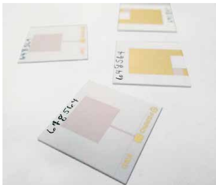
4 Купоны для электрических испытаний керамики. Размер образца 43 × 43 мм
