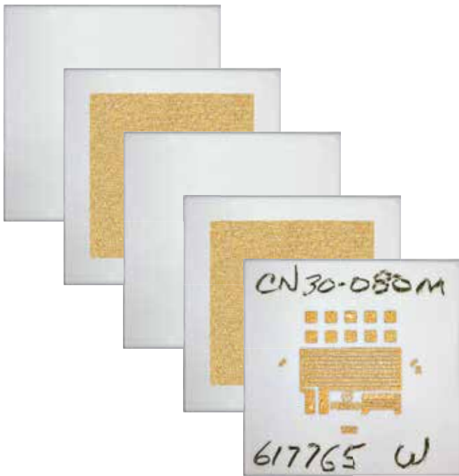
7 Тестовый купон для выходного контроля пасты. Размер образца 43 × 43 мм
