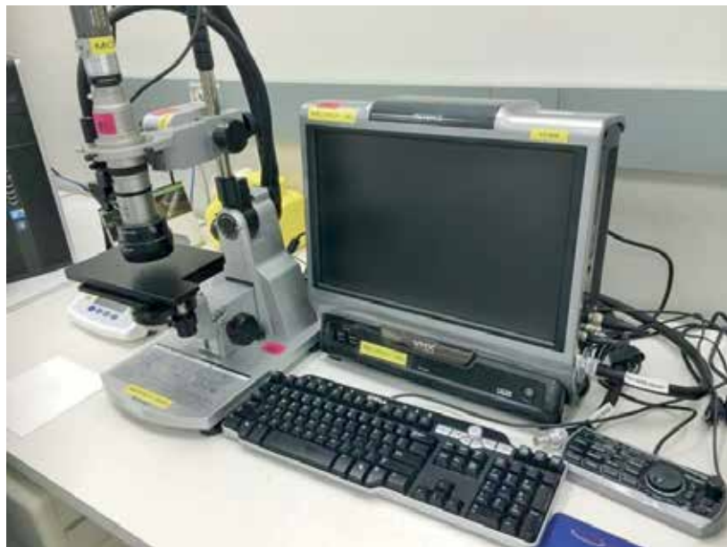
3 Форма тестового купона для проверки усадки – квадратная многослойная плата 43 × 43 мм со сквозными отверстиями (слева) и измерительный микроскоп, на котором контролируется усадка (справа)
